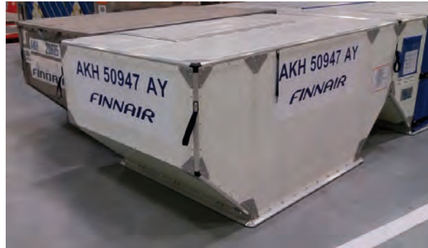
Finnairin Euroopan-lennnoilla käytettäviä AKH-tyypin kontteja. Kuva: Markus Pajarre
